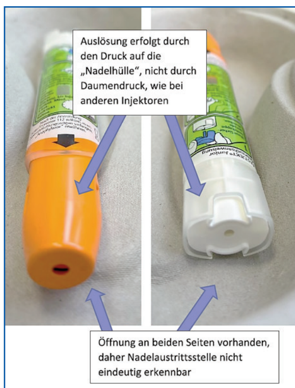
Abbildung 3: Fastjekt Junior: Nach Entfernung der blauen Sicherheitskappe weisen beide Enden des Produkts eine Öffnung auf, sodass es nicht ersichtlich ist, wo sich die Injektionsnadel befindet, die erst durch Druck selbsttätig heraustritt. (Genehmigung zur Bildnutzung liegt vor)
