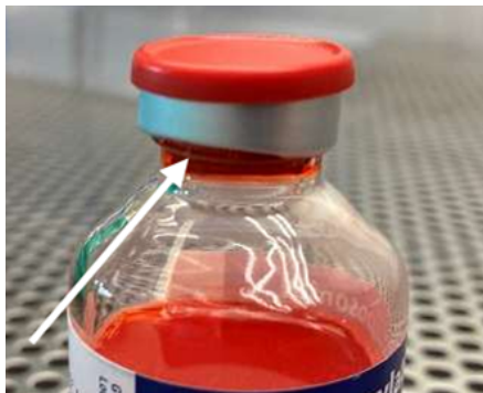
Abb 1. Beispiel für eine Auffälligkeit bei der Aluminiumverbördelung
