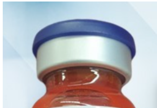
Abb 2. Beispiel für eine korrekte Aluminiumverbördelung
